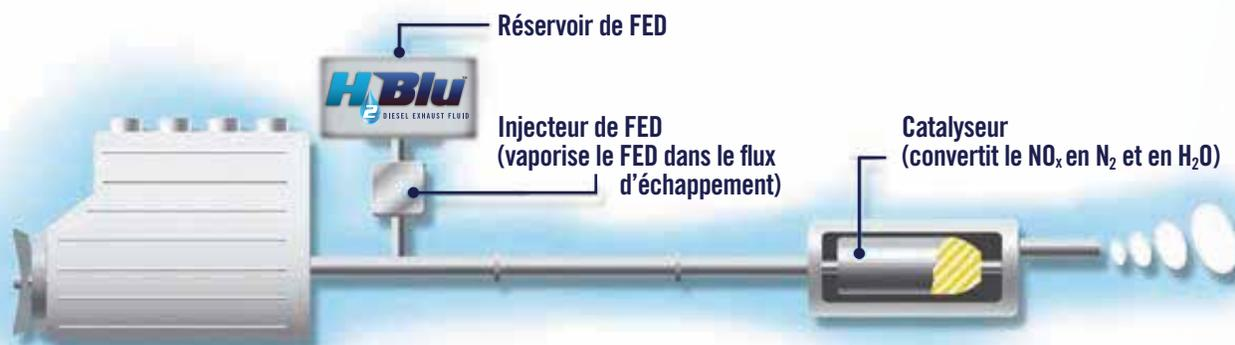
La technologie RCS réduit la concentration des gaz d'oxyde d'azote (NO<sub>x</sub>) produits à l'intérieur du moteur pendant la combustion. Ce processus requiert une quantité précise de FED devant être injectée dans le flux d'échappement. En se mélangeant aux gaz d'échappement, il est hydrolysé, puis le catalyseur décompose l'oxyde d'azote (NO<sub>x</sub>) en azote (N<sub>2</sub>) inoffensif et en eau (H<sub>2</sub>O).
